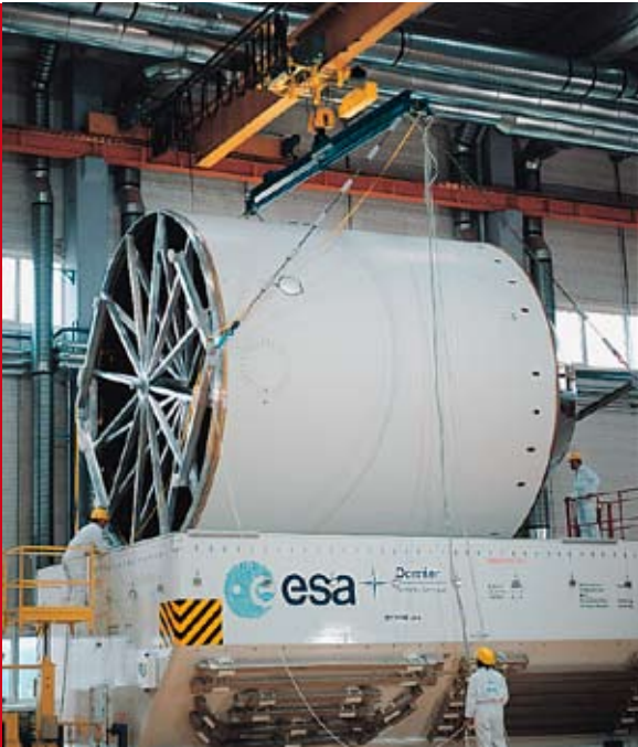
JDN im Dienste der Raumfahrt. Für den Transport der ARIANE-Raketenstufe entwickelten die JDN-Ingenieure das JDN-Gleichlauf-Hub- und Wendegerät
