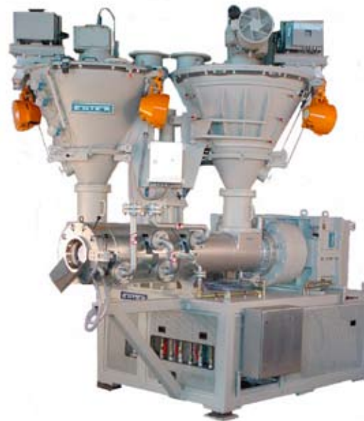
Bild 3: TP-WE 250/1000-M1 Standard Planetwalzenextruder für die Kunststoffindustrie
