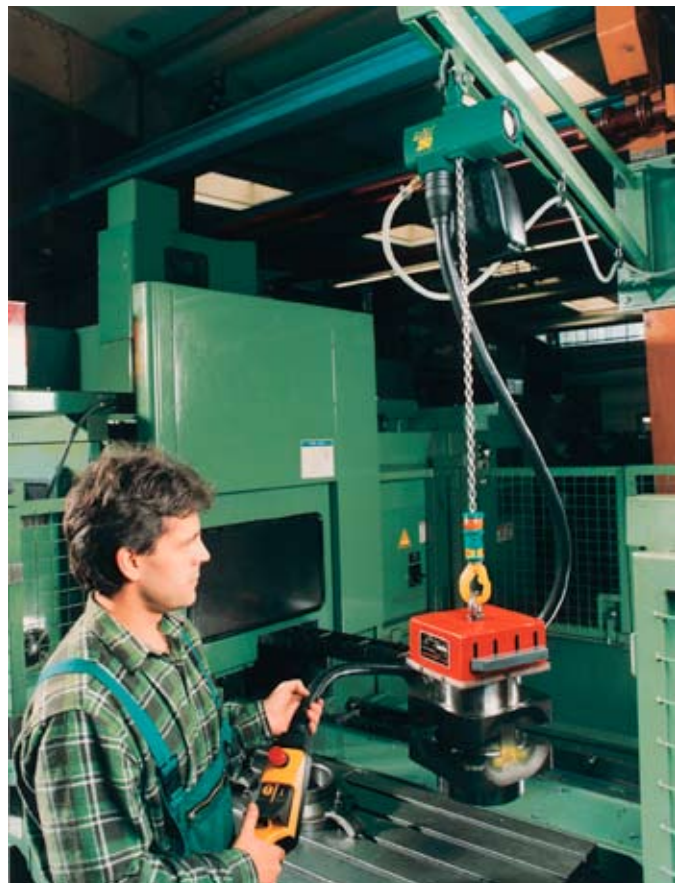
JDN-Druckluft-Hebezug mini 250 beim Einsatz an einem Bearbeitungszentrum zum Handling der Werkstücke
