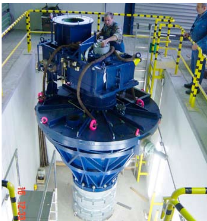
Bild 5: Planetwalzenextruder zur Klärschlammaufbereitung
