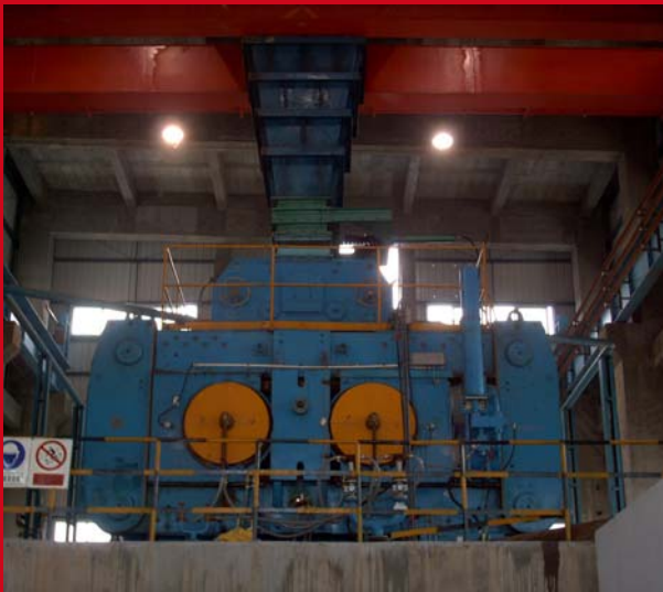
Gutbettwalzenmühle im Einsatz bei Ma-Steel, Anhui, VR China 中国马钢高压辊磨运行现场
