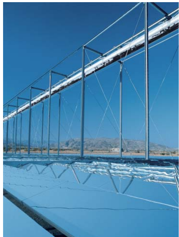
Optimale Raumausnutzung durch in Reihen angeordnete Flachspiegel
