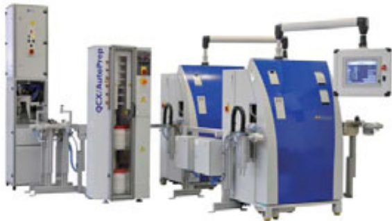
CENTAURUS, zum Vermahlen und Verpressen von körnigen Proben innerhalb eines Gerätes
