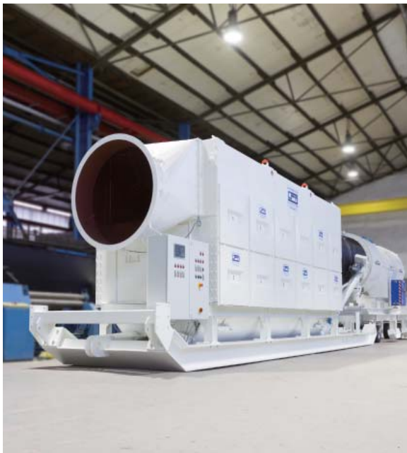
CFT Trockenentstaubungsanlage mit nachgeschalteter Korfmann Ventilatorstation und Verbindungslutze vor der Auslieferung im Werk Gladbeck
