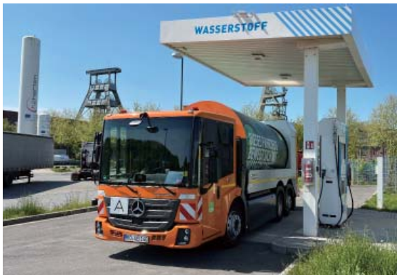
ENGINIUS BLUEPOWER mit Wasserstoff-Brennstoffzellen-System
